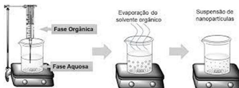
Figura 2: Esquema do método de obtenção nanopartículas poliméricas por nanoprecipitação. (11)
