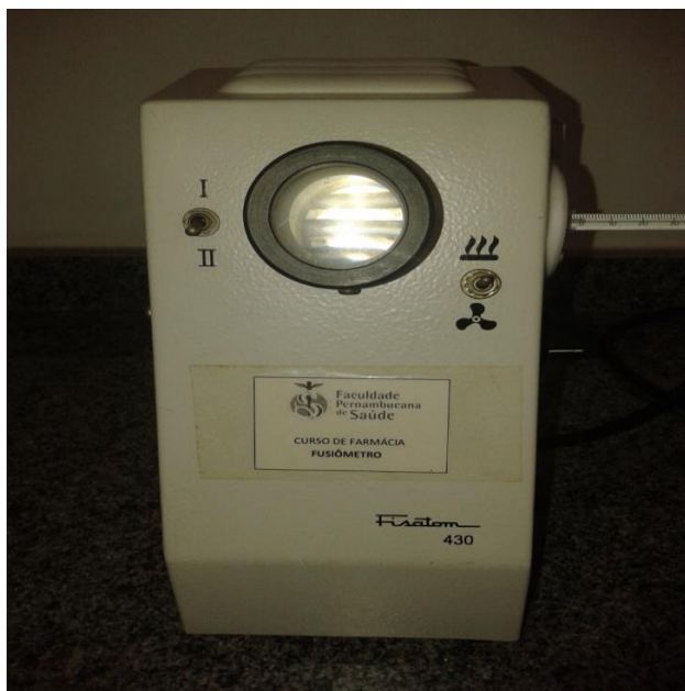
Figura 5 – Fusiômetro de Placa de Peltier, Modelo 430, Fisaton
