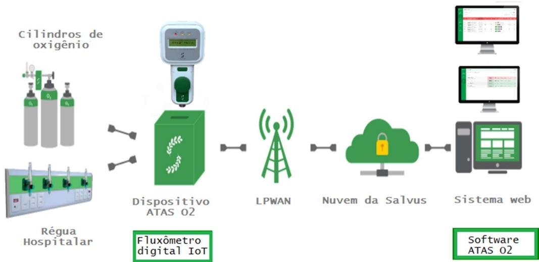
**Figura 3: Fluxômetro digital IoT ATAS O<sub>2</sub>**
