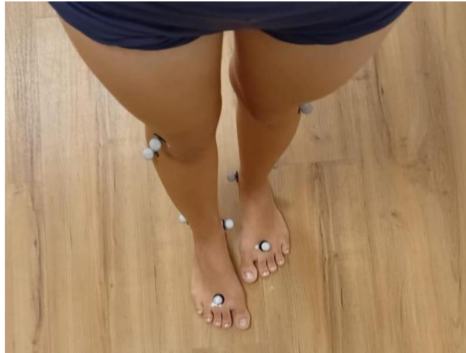
Figura 2: Imagem do posicionamento dos marcadores
